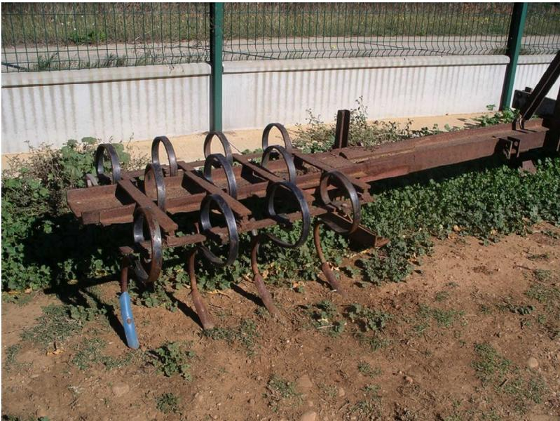
Il s'agit d'un IPN de 3 mètres de longueur, à l'extrémité de laquelle est soudé un cadre sur lequel sont fixées des dents de vibroculteurs « Cross killed ». 10 dents vibrantes permettent de gratter le sol sur 80 cm à 1 m de large.
