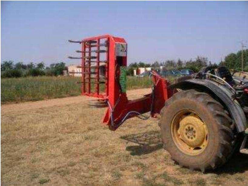
*Ainsi replié, et verrouillé avec une clavette de sécurité, l'outil peut plus facilement emprunter des chemins ou des petites routes.*
