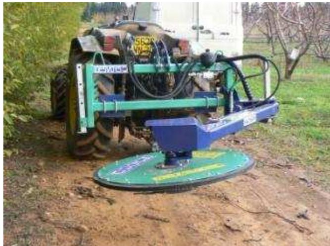
Ici montée à l'arrière du tracteur, ce dispositif peut aussi être monté à l'avant. Le grand diamètre de la tête est un atout pour la largeur de travail. La réalisation est toutefois plus difficile en verger très dense (moins de 3 mètres entre arbres sur le rang).
