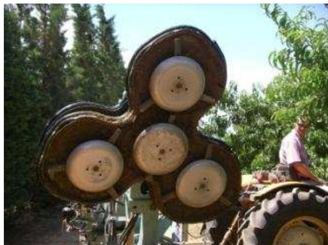
Ce type de tête qui tourne autour de l'arbre finit très bien le travail. De plus, selon les vergers, un passage par rang suffit. Ce type d'outil est derrière le tracteur et nécessite une bonne maîtrise de conduite et de réglage.
