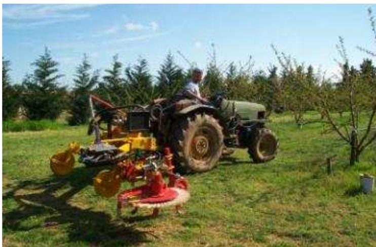
*Vue générale de l'Arbocep équipée d'une Fraise dans un verger de pêchers en conventionnel et adapté.*
