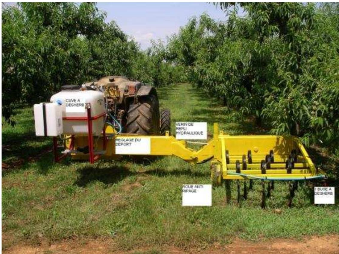
*L'outil en configuration complète avec la cuve à désherber et la buse en bout d'outil. Cette buse placée à l'arrière du bâti portant les dents sera déplacée devant.*
