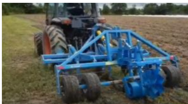
Passage du striptill directement après l'exportation du couvert pour la modalité 2
