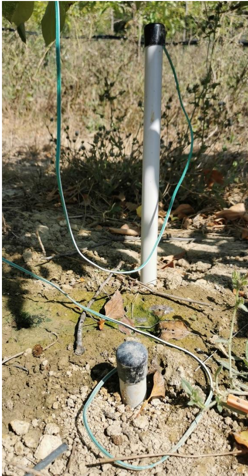
Figure 13 : Photographie de sondes Watermarks installés dans la parcelle OREVE
