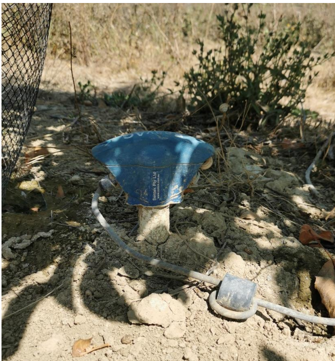
Figure 16 : Photographie d'une sonde capacitive installée dans la parcelle OREVE
