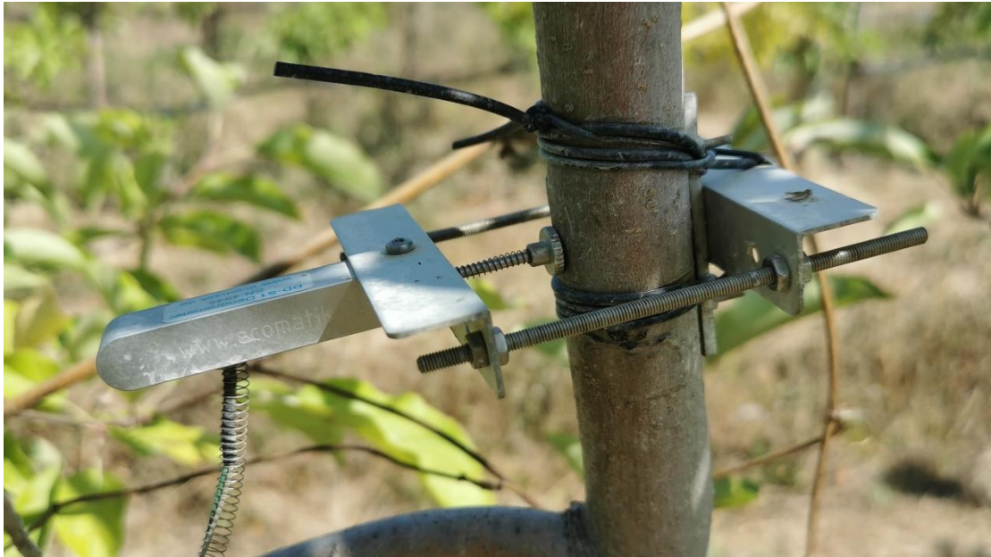
Figure 15 : photographie d'un dendromètre installé dans la parcelle OREVE
