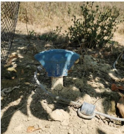
Figure 16 : Photographie d'une sonde capacitive installé dans la parcelle OREVE
