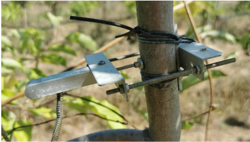
Figure 15 : photographie d'un dendromètre installé dans la parcelle OREVE
